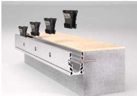
**2** Legen Sie die Klammern alle 200 mm in das Profil. Legen Sie die Klammern nicht über die Stellschrauben.
