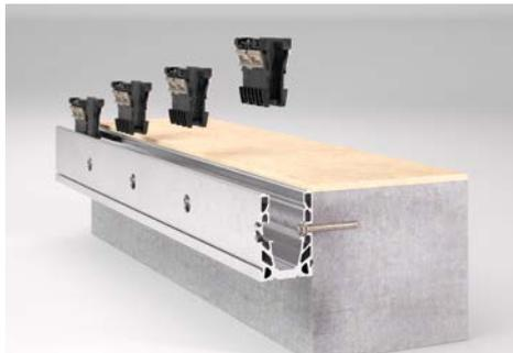
**2** Legen Sie die Klammern alle 250 mm in das Profil. Legen Sie die Klammern nicht über die Stellschrauben.
