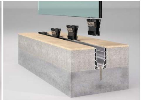
**3** Legen Sie die Klammern alle 250 mm in das Profil. Legen Sie die Klammern nicht über die Stellschrauben.
