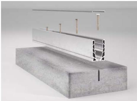
**1** Bohren Sie Löcher in die Platte, positionieren Sie das Profil, die Befestigungsschrauben und die provisorische Abdeckungsverkleidung, um zu verhindern, dass die Zuschlagstoffe das Profil während des Einbaus verschmutzen.
