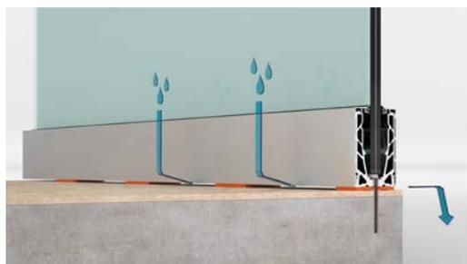
Accessorio perforato in alluminio da posizionare alla base del profilo (n° 4 pezzi ogni metro lineare), in corrispondenza dei fissaggi alla sottostruttura in modo da rialzare tutto il sistema di 5 mm e permettere all'acqua di defluire.
