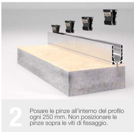
**2** Posare le pinze all'interno del profilo ogni 250 mm. Non posizionare le pinze sopra le viti di fissaggio.
