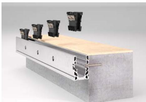
**2** Posare le pinze all'interno del profilo ogni 200 mm. Non posizionare le pinze sopra le viti di fissaggio.
