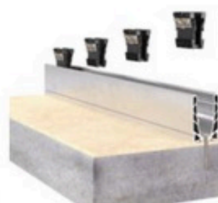
2 Posare le pinze all'interno del profilo ogni 25 cm. Non posizionare le pinze in corrispondenza delle viti di fissaggio
