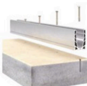
1 Forare la soletta con il trapano, posizionare il profilo e le viti di fissaggio
